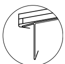
raccord à l'égout debout, en biais, tête fermée
